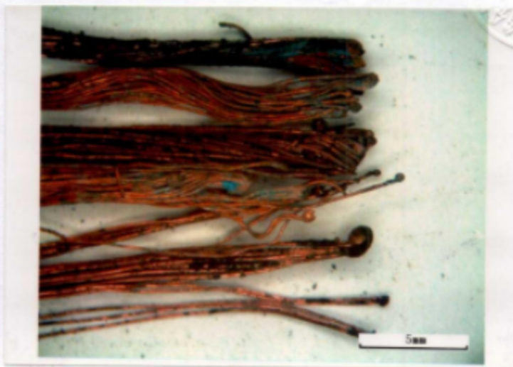
照片 3 送检的 1 号样品：排插电源线残线上熔痕外观（体视镜 8×）
