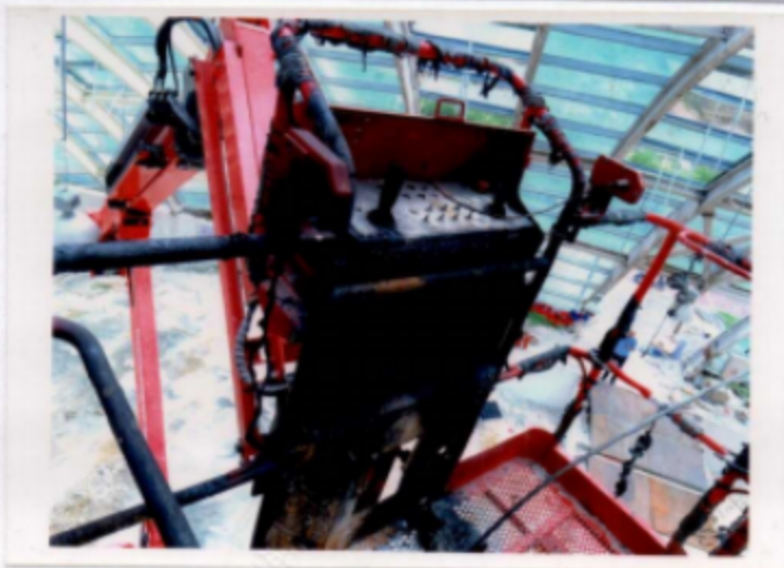
照片 8 送检的 3 号样品：高空作业车过火区域的线路残骸外观
