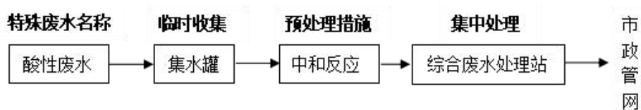
图 4-3 检验科特殊废水处理工艺流程图
